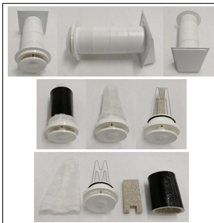
Kuva 2. Kuvia mitatusta venttiilikokonaisuudesta ja äänenvaimennusosista.
